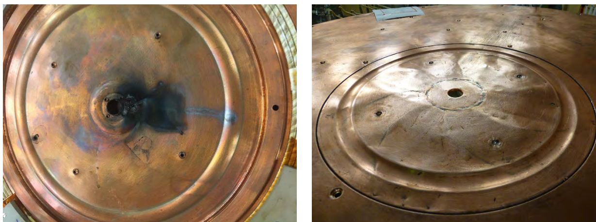
Poškozená centrální oblast před a po opravě.
