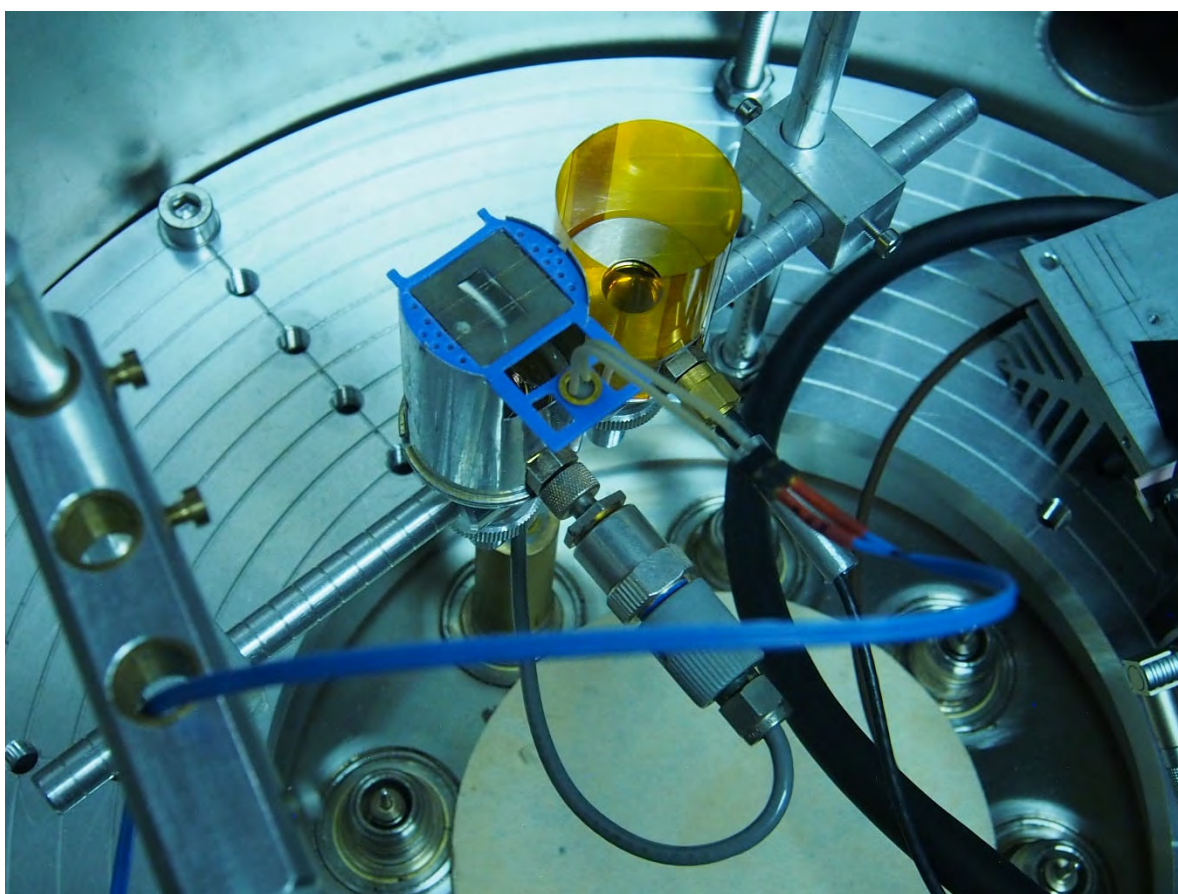
Pohled na experimentální uspořádání ve vakuové komoře metody neutronového hloubkového profilování NDP. Vzorek baterie (uchycený v modrém rámečku) je umístěn v držáku nad detektorem nabitých částic.
