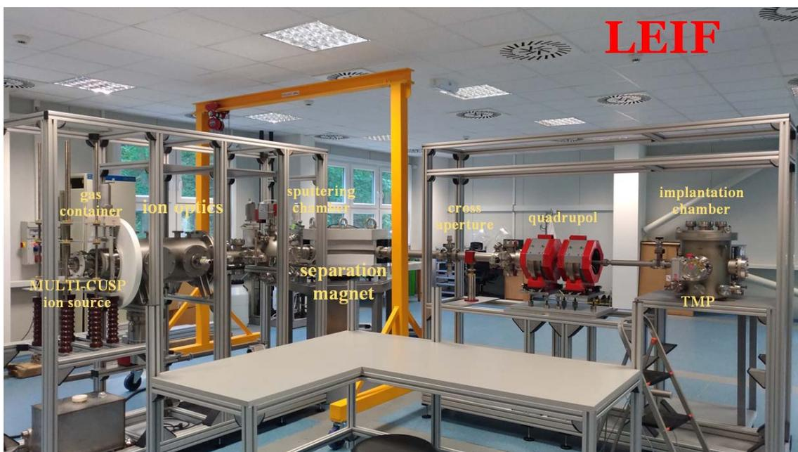
Obr. 5. Zařízení LEIF (Low Energy Ion Facility).
