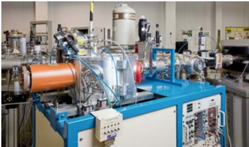
▪ Obr. 3: První RBS kanálovací analytické zařízení instalované v Laboratoři Tandetronu v roce 2006. Foto: Archiv ONIM
