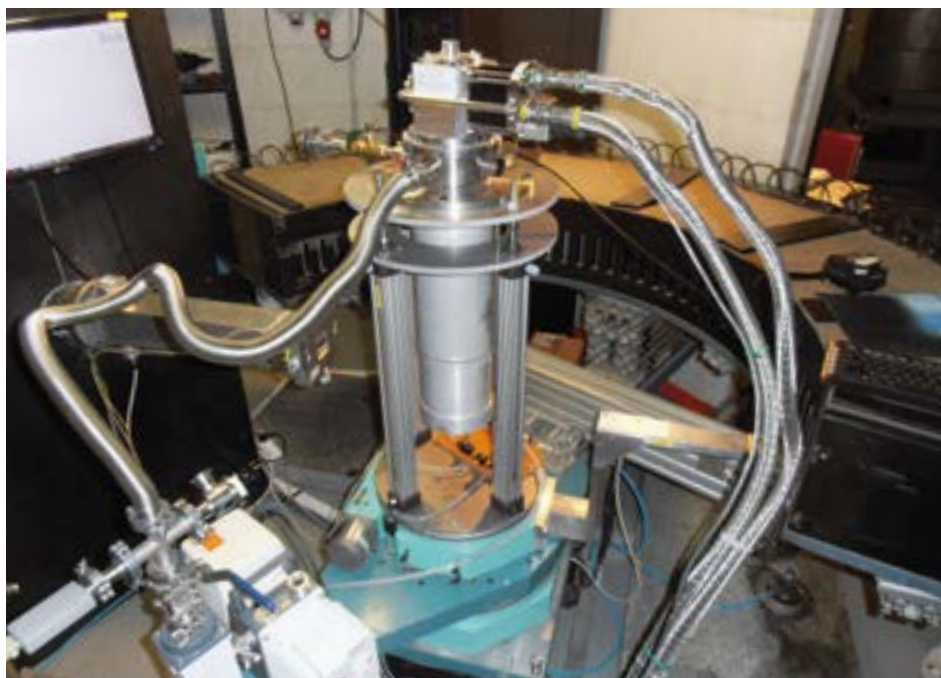
▪ Obr. 2: Neutronový práškový difraktometr MEREDIT v uspořádání s kryostatem. Foto: Archiv CANAM
