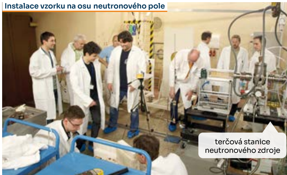
▪ Obr. 3: Test radiační odolnosti elektroniky kalorimetru LHC CERN: (a) Instalace komponent k terčové stanici. Foto: Archiv CANAM
