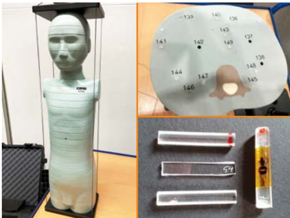
▪ Obr. 3: Pediatrický fantom (10 let) s detektory stop. Tyto detektory je možné umístit uvnitř antropomorfního dětského fantomu do pozic představujících různé orgány. Foto: Archiv ODZ
