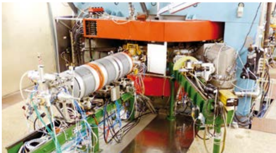
▪ Obr. 1: Izochronní cyklotron U-120M s ionto-optickou trasou pro transport iontů ze záporných režimů. Foto: Archiv OU
