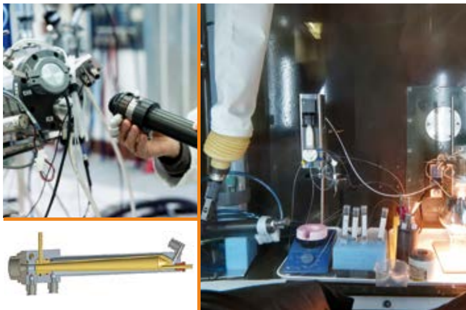
• Obr. 5: Nový kompaktní terč pro přípravu ^{83}\text{Rb} na cyklotronu TR-24 (vlevo). Záběry z přípravy emanačního generátoru ^{83}\text{Rb}/^{83\text{m}}\text{Kr} v horké komoře (vpravo). Foto: Archiv ORF
