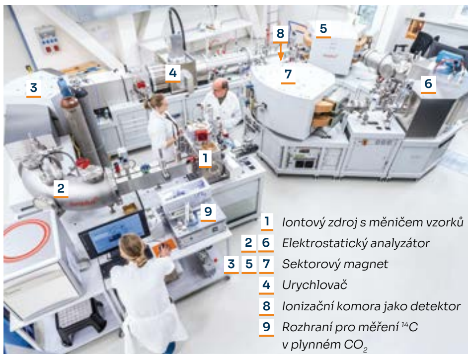
▪ Obr. 3: Systém AMS MILEA. Foto: AV ČR – J. Plavec
