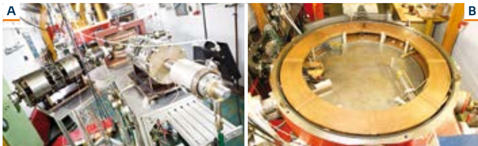
▪ Obr. 7: Záběry z mikrotronové laboratoře. A: Vývody svazků elektronů jsou opatřeny kvadrupólovými dublety, které slouží k fokusaci, na konci trasy vpravo je umístěn W konvertor sloužící pro konverzi elektronů na fotonový svazek. B: Pohled na otevřený mikrotron, na okrajích urychlovací komory je měděné vinutí zajišťující homogenní magnetické pole, v levé části rezonátor, napravo vývod svazku. Foto: Archiv OU
