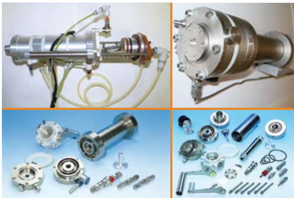
• Obr. 3: Vlevo jeden z prvních modelů držáku externího pevnolátkového skloněného terče s vodním a heliovým chlazením pro přípravu ^{124}\text{I} . Vpravo původní model plynového terče pro přípravu izotopů rubidia. Dole modely rozebrané na součástky. Foto: Archiv ORF
