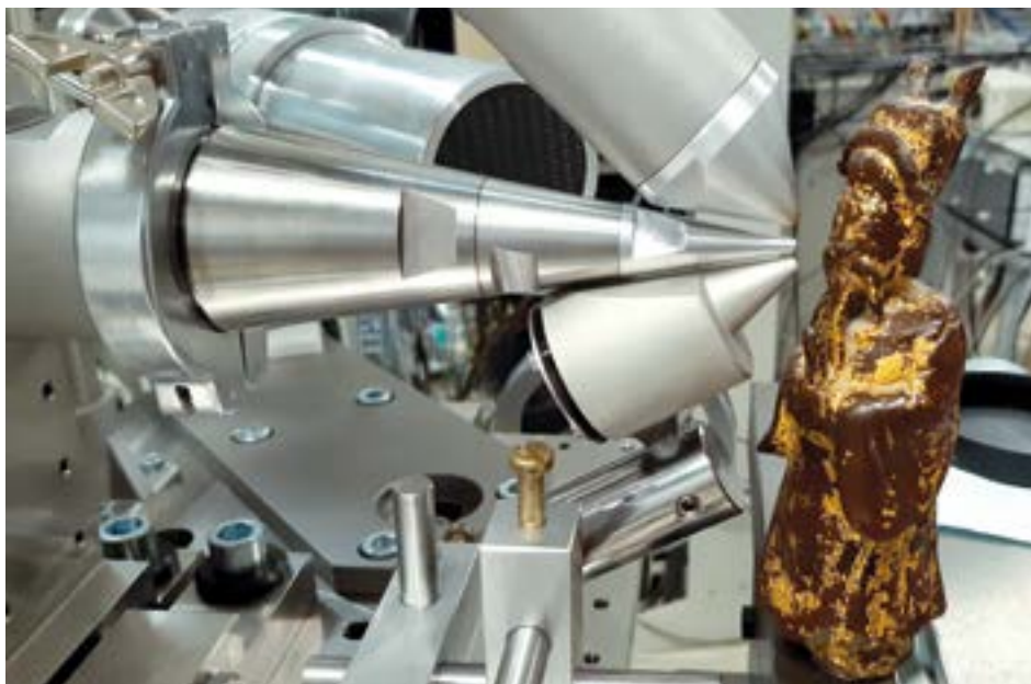
■ Obr. 7: Vývod externího svazku iontů do vzduchu s přídatnými detektory pro charakterizaci prvkového složení metodami RBS, PIXE a PIGE. Foto: Archiv ONIM
