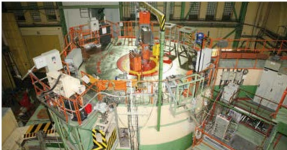
▪ Obr. 4: Pro neutronovou aktivační analýzu jsou užívány neutrony z vertikálních kanálů reaktoru LVR-15 (provozovatelem reaktoru je CVŘ s.r.o.). Foto: Archiv ÚJF
