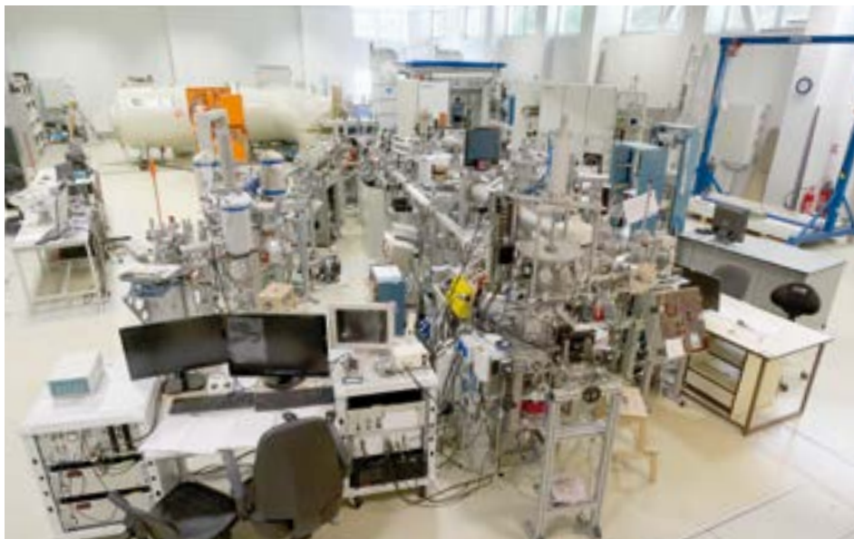
▪ Obr. 8: Současný stav instrumentace v Laboratoři Tandetronu – nová trasa pro iontovou implantaci uprostřed, obsazeno všech 5 výstupů magnetu urychlovače. Foto: Archiv ONIM
