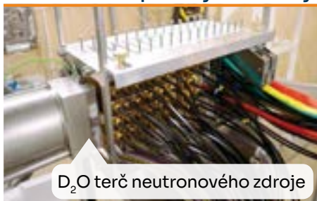
• Obr. 3: (b) Uspořádání komponent k průtočnému D_2O terči generátoru neutronů. Foto: Archiv CANAM
