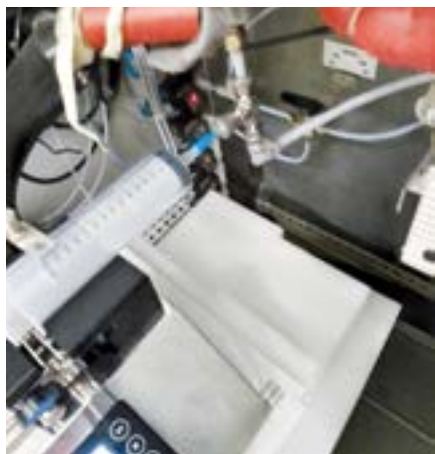
▪ Obr. 4: Odběr kumulovaného vzorku spalín do 150 ml „injekční stříkačky“ pro analýzu ^{14}\text{CO}_2 , spalovna odpadů v Liberci. Foto: Archiv CRL
