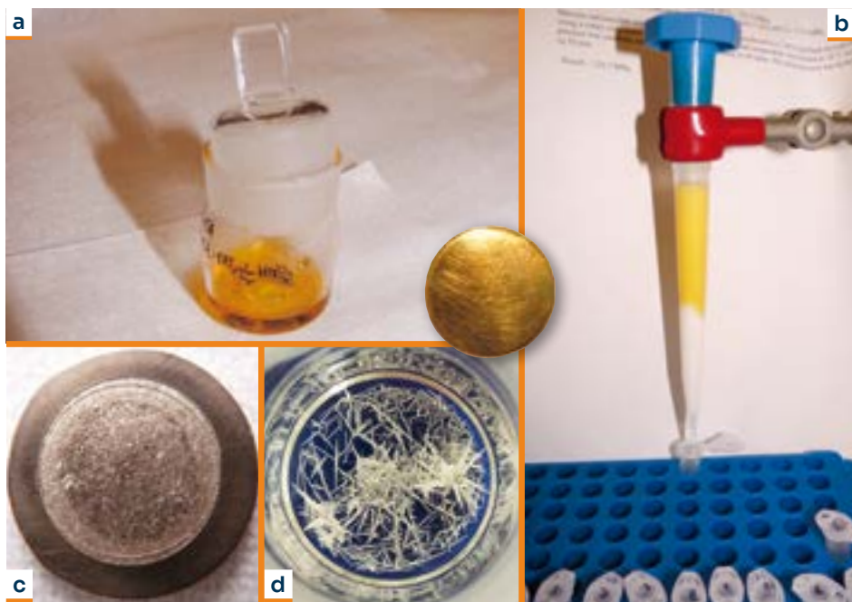
• Obr. 4: Zleva: a) ozářený zlatý terč a jeho roztok v lučavce královské; b) následná separace ^{197\text{m,g}}\text{Hg} na koloně; c) niklový terč po ozáření deuterony a odleptání aktivované vrstvy kyselinou chlorovodíkovou; d) krystaly dusičnanu thallného vypadlé z přesyceného roztoku thallného terče rozpuštěného v kyselině dusičné. Foto: Archiv ORF
