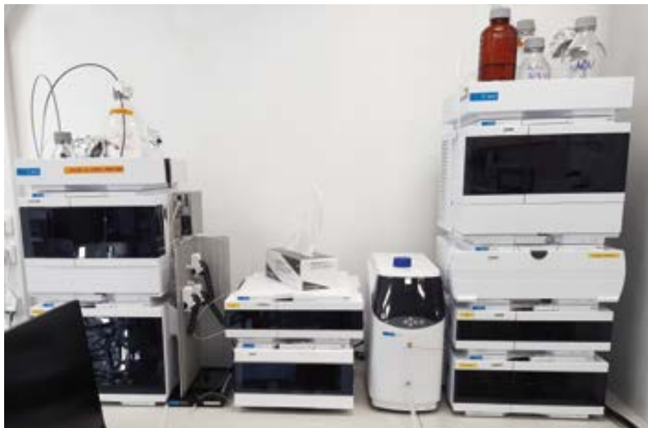
■ Obr. 1: Systém analytického a preparativního kapalinového chromatografu Infinity 1260 (Altium, CRL Řež). Foto: Archiv CRL
