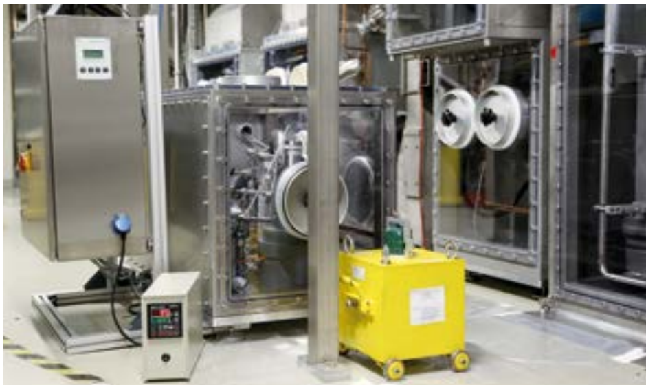
▪ Obr. 3: Zařízení pro injekci ^{83\text{m}}\text{Kr} z našeho zdroje do tritiového okruhu KATRIN a žlutý kontejner pro transport zdroje. Z důvodu radiační bezpečnosti se zařízení nachází uvnitř vakuově uzavřeného boxu (na obrázku uprostřed). Vlevo je skříň s rozvodem elektrického napájení a kontroler pro ohřev pece zařízení. Foto: Archiv ÚJF
