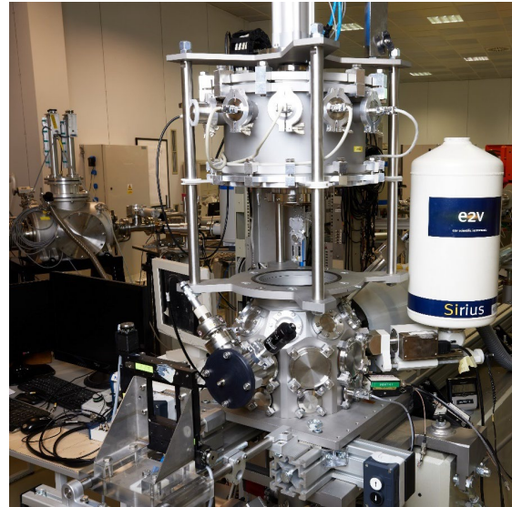
Obr. 2. Nová vakuová komora mikrosvazku s otočným vzorkovníkem pro 3D prvkovou tomografii.
