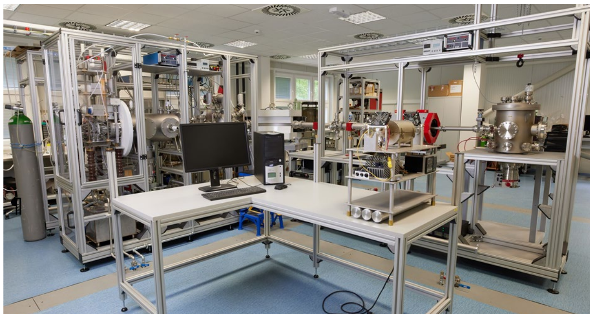
Obr. 5. Systém LEIF (Low Energy Ion Facility) pro přípravu tenkých vrstev metodou iontového naprašování, implantace nízkoenergetických iontů a ozařování materiálů.
