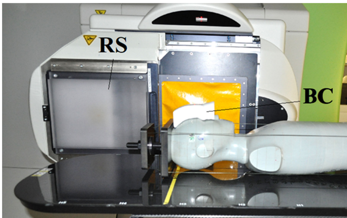
Antropomorfní fantom desiletého dítěte s 3D tištěným kompenzátořem svazku (BC). Vlevo měnič dosahu protonů (RS) (převzato z Wochnik A. et al., Phys. Med. Biol. 66 (2021) 035012).
