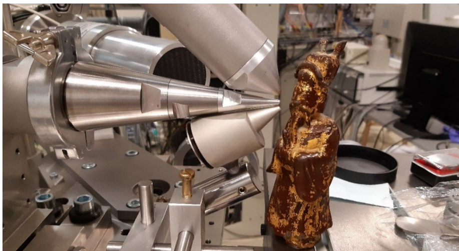
Obr. 5. Koncový vývod iontového svazku do vzduchu s nástavci detektorů PIXE, RBS a PIGE, vhodný například pro prvkovou analýzu předmětů kulturního dědictví.
