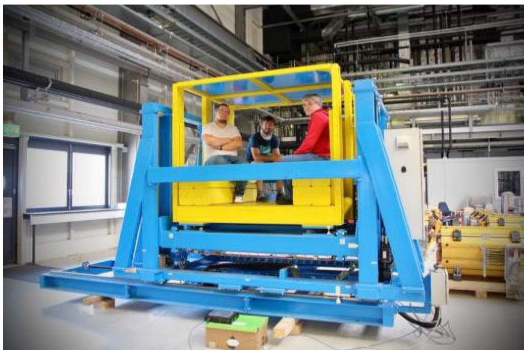
Manipulátor pro polohování PSD detektoru.
