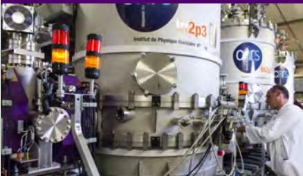
Kryogenické komory ukrývají rezonanční kavitu supravodivého urychlovače SPIRAL2.
