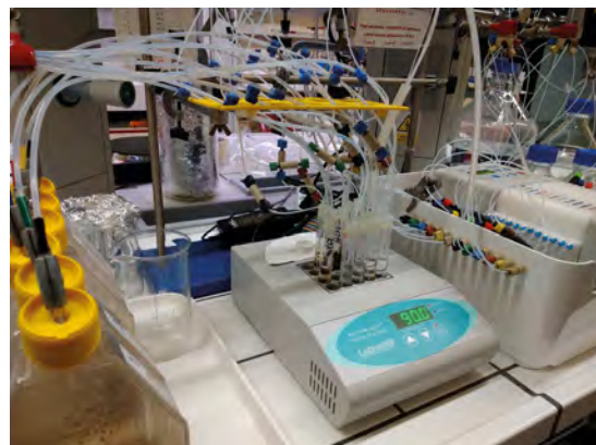
Aparatura k předúpravě vzorků pro radiouhlíkové datování v laboratoři CRL, jejíž pracovníci a vybavení se zčásti přesunou do laboratoře AMS po jejím dokončení. Foto: ÚJF AV ČR
