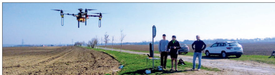
K měření i výcviku pilotů bezpilotního vrtulníku Velos slouží také dron DJI F450
