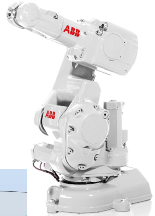
ABB IRB-140 robot maximum load 6 kg
